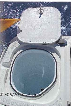
Dies ist keine Außentoilette, sondern ein Fischbehälter
