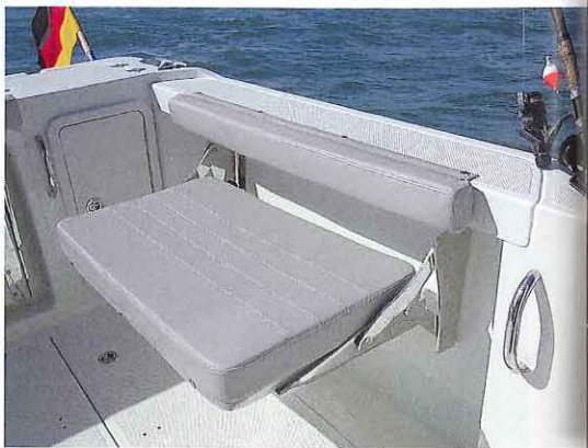
...Cockpit der Quicksilver sind mit einem ausgeklügelten Klappmechanismus versehen
