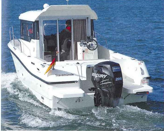
Auch die Heckpartie des Pilothouse-Cruisers ist gelungen. Die Badestege sind stabil befestigt, an Steuerbord gibt es eine Leiter
